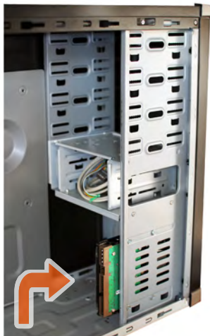
Seitenansicht BC-08 mit hochkant eingebauter Festplatte (Festplatte nicht im Lieferumfang enthalten)
