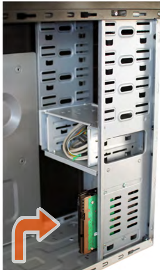
Seitenansicht BC-15 mit hochkant eingebauter Festplatte (Festplatte nicht im Lieferumfang enthalten)
